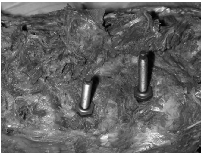
Abb. 1 Wirbelsäulenpräparat mit zwei ventral implantierten Schrauben; links nach Implantation in weichen, rechts in ausgehärteten Knochenzement.
